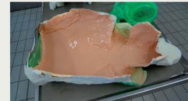
Abb. 4: Ausgehärteter Silikonguss
